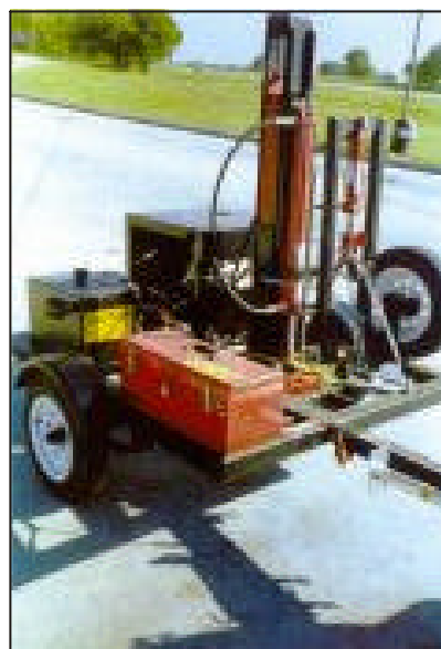
DigiPulse Model 1180-TMH 動力源： ゴムバンド 探査深度： 300 - 1000 m
