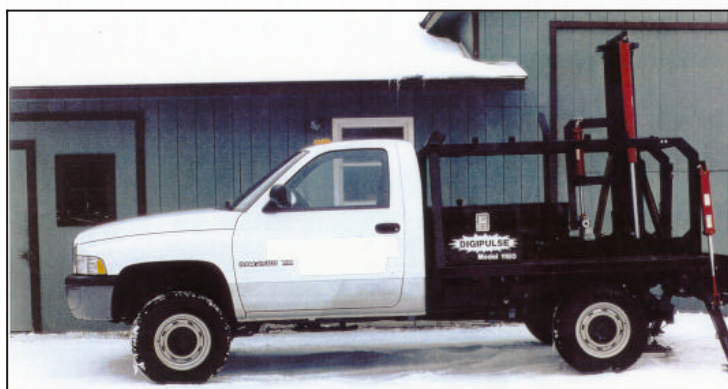
DigiPulse Model-AWD1180 動力源： 圧縮窒素ガス 探査深度： 600 - 5000 m
